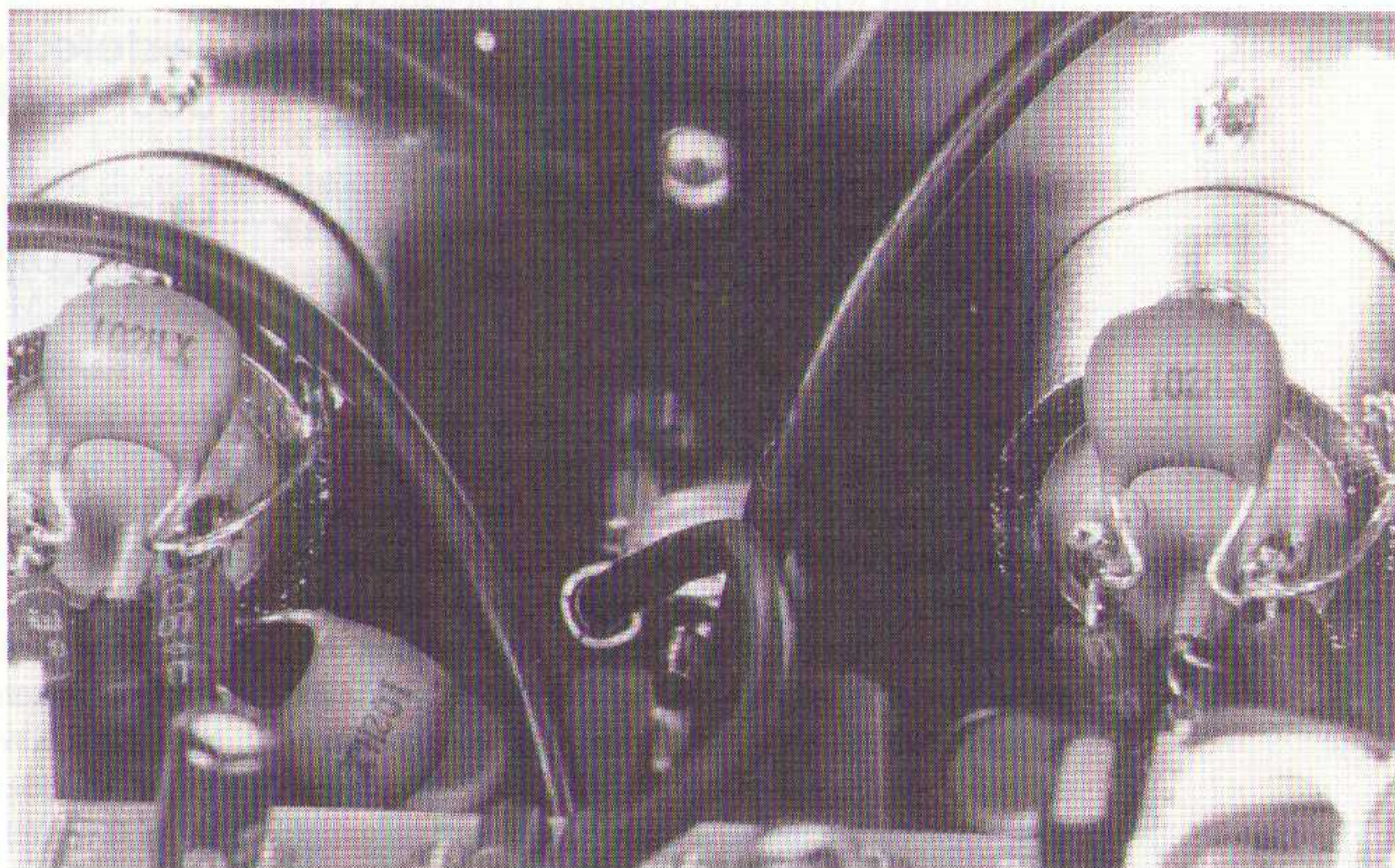
Op de XLR-uitgangen is een FTZ-netwerkje aangebracht.
